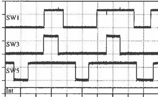
Figura 6. Señales de disparo de los IGBT's e interrupción al Microprocesador. Eje x 0.5 ms/div. Eje y en 10 V/div
